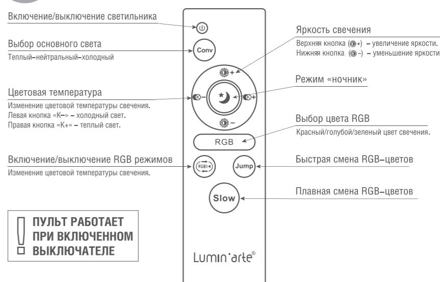
**ПУЛЬТ РАБОТАЕТ ПРИ ВКЛЮЧЕННОМ ВЫКЛЮЧАТЕЛЕ**
